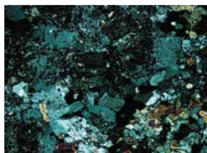
Рис. 13. Роговик под микроскопом
