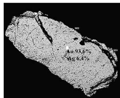
Рис. 6. Изображение золотинки в электронном микроскопе, показан анализ минерала в точке (белое)
